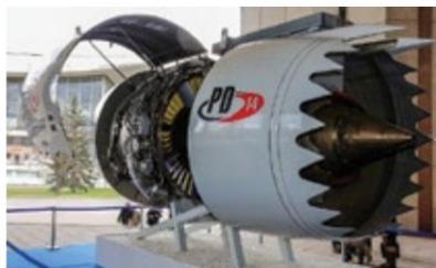
Впервые в отечественной инженерной и технологической практике сконструирована и изготовлена мотогондола ПД-14 из полимерных композиционных материалов. Для деталей и агрегатов мотогондолы в ВИАМ были созданы препреги, угле- и стеклопластики, которые по характеристикам не уступают лучшим мировым аналогам и производятся в институте.
